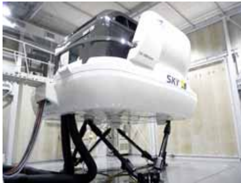
CAE社製7000シリーズ フル・フライト・シミュレーター Head Up Display (HUD) を装備
